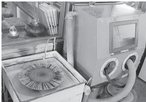
右がサンドブラストの機械。 左はガラスを削る旋盤
